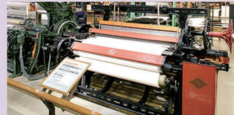
阪本式管替式自動織機 SO-A型 Sakamoto Cop-Change Automatic Loom, Type SO-A
